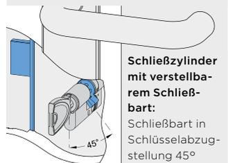
**Schließzylinder mit verstellbarem Schließbart:**
