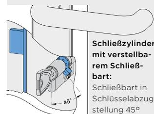
**Schliezylinder mit verstellbarem Schliebart:**
