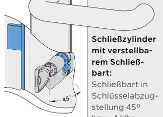
**Schließzylinder mit verstellbarem Schließbart:**
